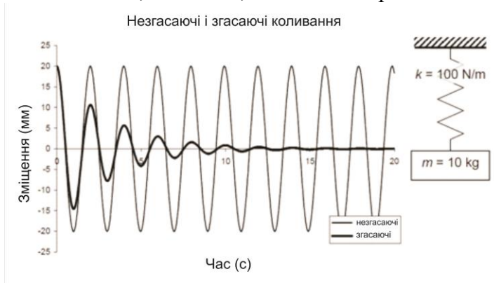
Рис. 8.8. Незгасаючі коливання – відповідна модель; поряд відповідна моделі із загасаючими коливаннями
